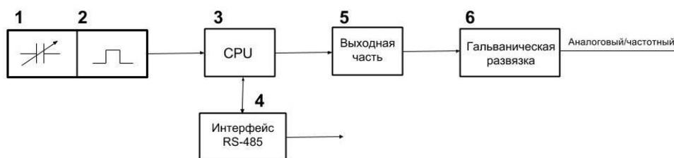
Рис. 1.5 Структурная схема ДУТ Siensor AF107
